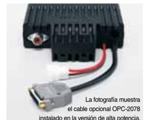
La fotografía muestra el cable opcional OPC-2078 instalado en la versión de alta potencia.
